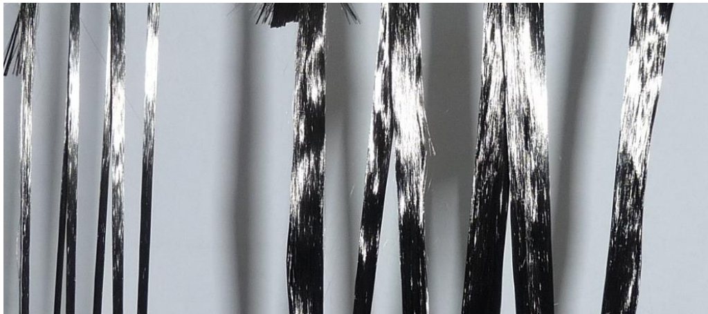
Carbonfilamente: schwarz, glänzend, <math><100\ \mu\text{m}</math> – Die Herausforderung für jede Bildbearbeitung. Foto: opdi-tex GmbH
